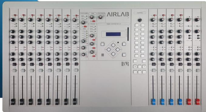
Airlab-DT es una consola de radio extremadamente fiable con un equilibrio perfecto entre prestaciones y sencillez de funcionamiento. Su ruta de señal analógica controlada digitalmente ofrece lo mejor de ambos mundos, garantizando la fiabilidad en cualquier condición.
