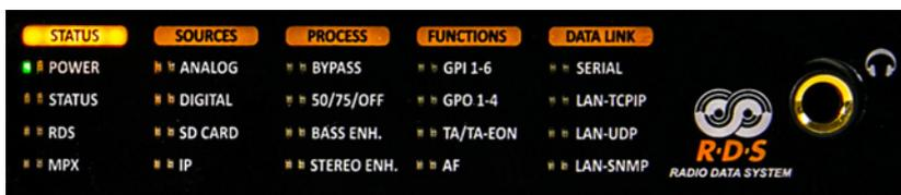
Un panel con 40 LED (el panel LCD en el modelo más grande) muestra información de estado. Los mensajes de alarma se pueden enviar a través de GPO, SNMP (Trap), http y correo electrónico.
